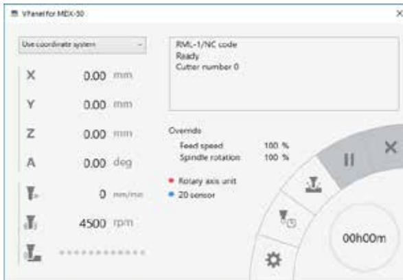
VPanel это приложение для управления машиной с экрана монитора. Он имеет функции для вывода данных резки, выполнения технического обслуживания и внесения различных корректировок. Он также отображает информацию о состоянии и ошибки.
